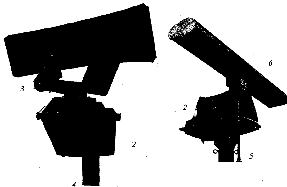
Sl. 5.3. Paraboloidna i valovodna antena
