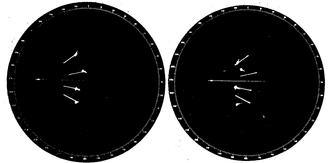
Sl. 7.17. Protusudarna radarska slika na zaslonu radara ARPA/RADAR DECCA lijevo – početno stanje: četiri mrlje brodova s elektronskim oznakama; mrlja s dugačkom crtom jest vlastiti brod i njegova kursna crta; desno – stanje nekoliko minuta kasnije: dvije mrlje na elektronskim oznakama prikazuju brodove opasne za sudar; ostale mrlje jesu neopasni brodovi
