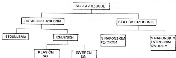
Sl. 3.3.7. Blokvska shema podjele sustava uzbuđe prema vrsti uzbudnika
