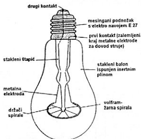
Sl. 6.3.8. Žarulja sa spiralnom volframovom niti
