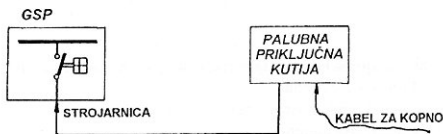
Sl. 4.2.9. Blokovska shema priključka broda na kopno
